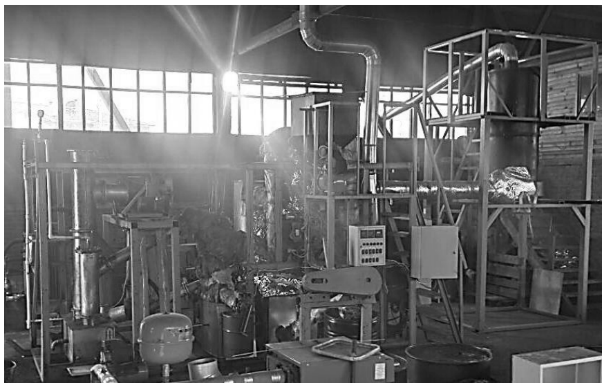
Рис. 3. Общий вид установки для термохимической переработки биомассы в жидкое топливо УБП-50
