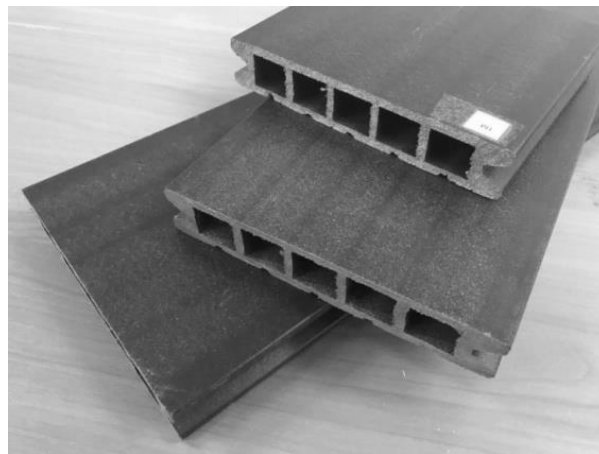
Рис. 1. Внешний вид террасных досок из ДПК на основе термомодифицированного древесного наполнителя
