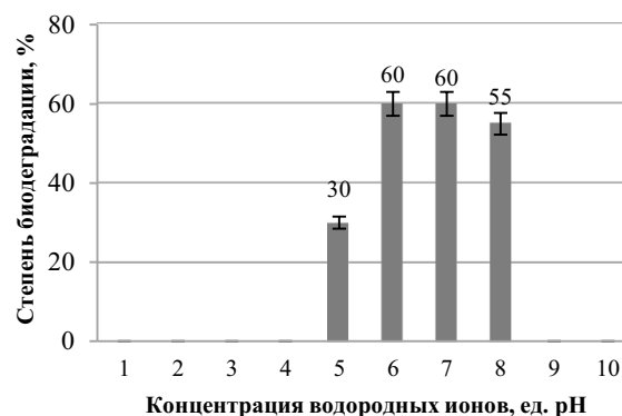
Рис. 1. Интенсивность биодegradации нитроцеллюлозы в зависимости от концентрации водородных ионов
