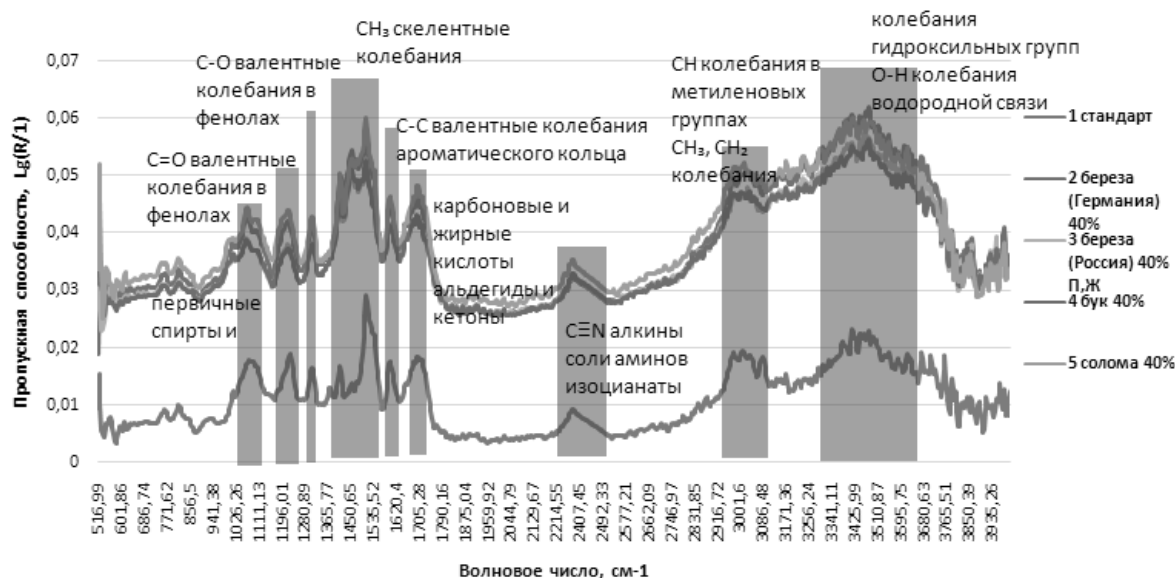
Рис. 7. ИК спектры образцов с содержанием 40% пиролизной жидкости
